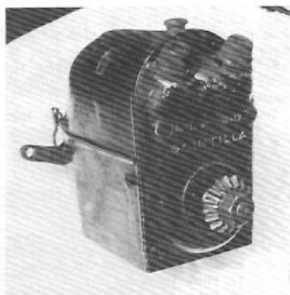
Magnéto Scintilla pour moteur bicylindre. On voit que son entraînement se fait par pignon d'angle
